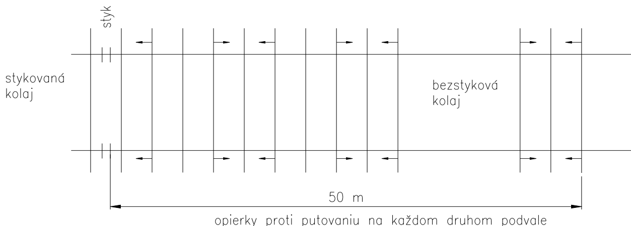
Obr. č. 3 Umiestnenie opierok proti putovaniu koľajníc
